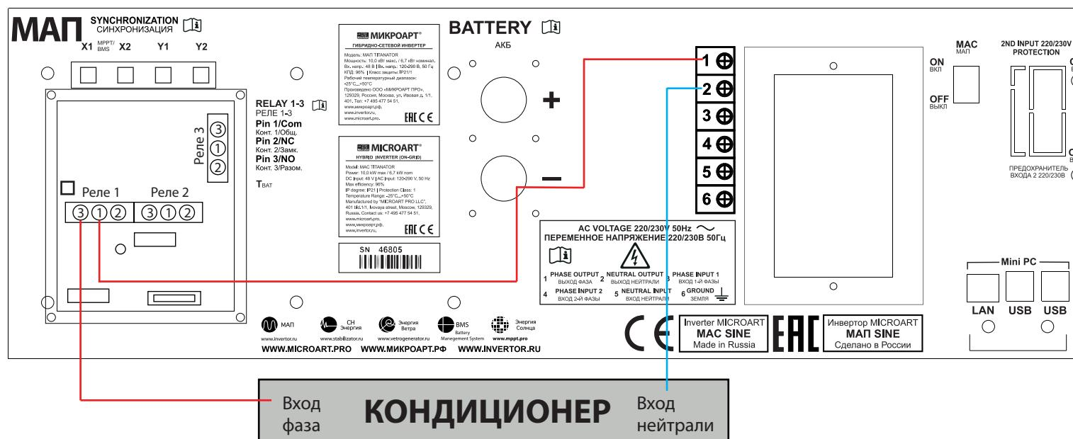
Типичный пример, подключения кондиционера по температуре датчика АКБ. Подробнее и с др. схемами можно ознакомиться в полной версии Приложений: "ПРИЛОЖЕНИЯ К ИНСТРУКЦИИ МАП ТИТАНОТОР. ПОЛНАЯ ВЕРСИЯ".
