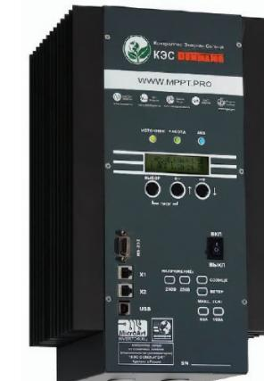
Необходимо подключить КЭС к МАП. Для этого у МАП (всех моделей) есть разъем подключения дополнительных устройств (телефонный) RJ-12 спереди с надписью «Такб/BMS/MPPT» (в старых моделях с надписью «MODEM») и для модели МАП DOMINATOR/TITANATOR такой же разъем сзади корпуса, с надписью «Такб/BMS». К этому же разъему подключается и BMS.
