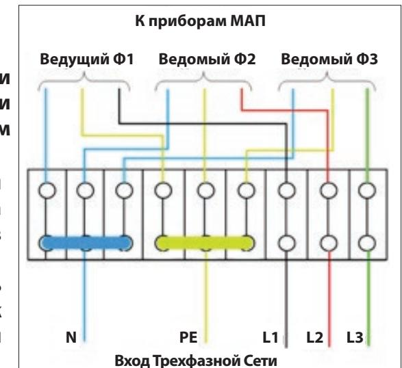
Рисунок 8\*. Схема соединения МАП при синхронной однофазной работе
