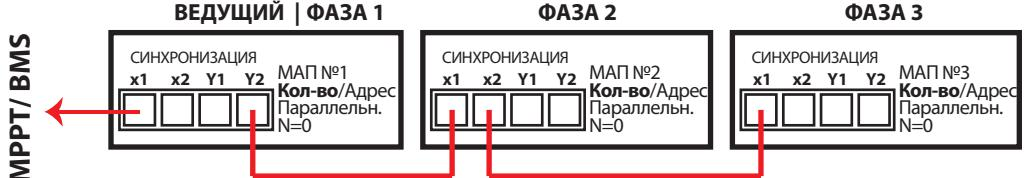
Рис.8 Схема трехфазного соединения.
