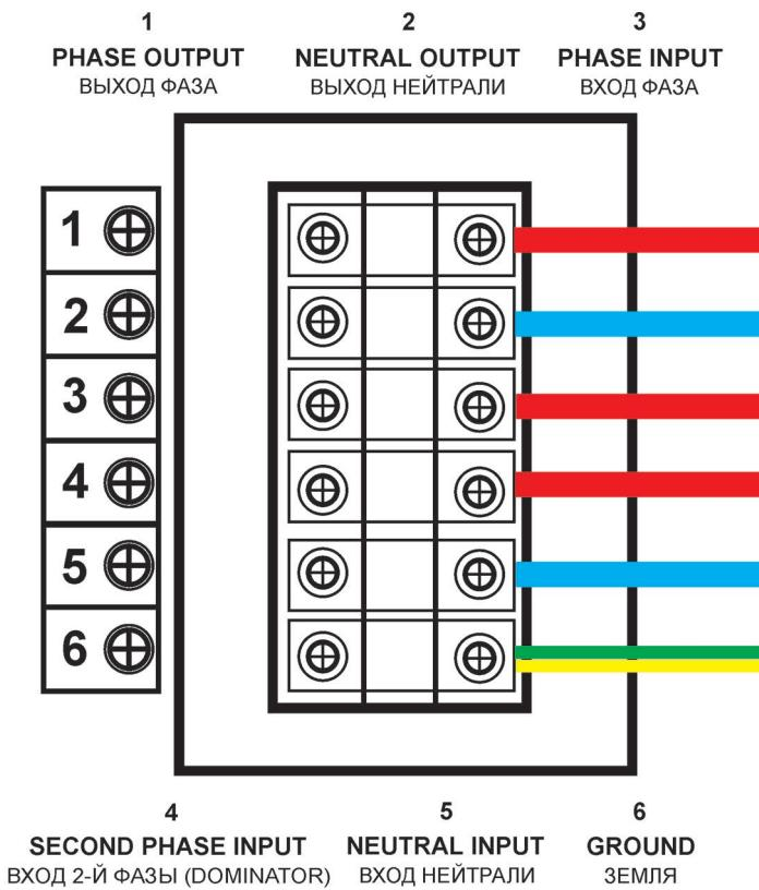
Рисунок 5. Клеммная колодка приборов мощностью от 3 кВт.
